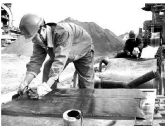
为进一步消除设备隐患,提高设备运转率,近日,氧化铝一分厂一车间组织人员对辖区内的设备、设施进行拉网式排查,共查出设备隐患8处,现场设施隐患6处,并及时安排专人负责整改,确保设备高效、安全、稳定运行。图为皮带维修班人员正在对南台主皮带进行胶结。摄影报道 原卢平
