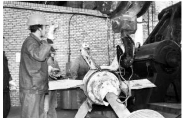
12月7日,在对氧化铝二分厂中碎工段3号收尘风机检修任务中,检修分厂综合车间施工人员加班加点,连续作业,经过30个小时的拼搏,顺利更换了叶轮等部件,确保了回转窑熟料输送过程的收尘效果达到节能降耗标准。图为检修人员在拆卸风机叶轮。摄影报道 张安泽 董晨虹
