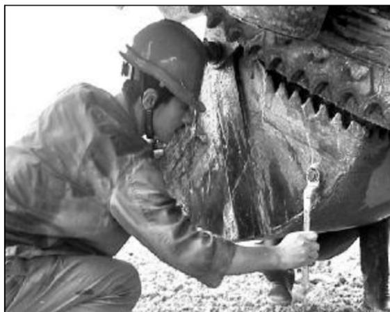
进入 9 月份,氧化铝一分厂储运车间组成生产保障队,加强堆场大型露天设备取料机的维护,为雨季供料创造条件。图为车间生产保障队员对取料机斗轮进行调节。
