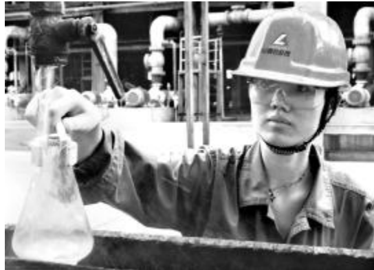
80万吨氧化铝厂四车间狠抓蒸发回水的指标,以合格的蒸发回水代替新水作为机封水收到良好效果。图为员工正在化验回水碱度。
