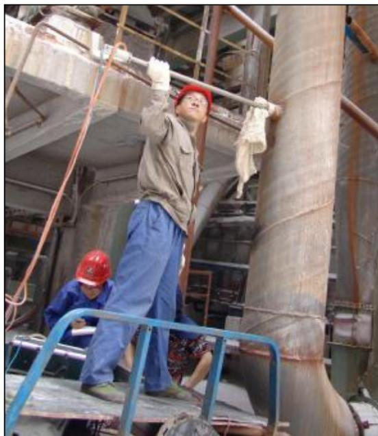
近日,技术中心对4号焙烧炉新增试验用布袋收粉器进行收尘试验,试验人员对各种工况条件下布袋收粉器的风量、含尘浓度等指标进行跟踪测试,同时与电收尘处理尾气结果进行了比较,测试结果显示布袋收尘效果良好,出口含尘量大大降低,有效降低烟气污染。图为试验人员精心试验。
