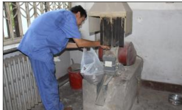
近日,技术中心技术应用研究室针对氧化铝生产瓶颈环节,积极开展技术应用试验研究,小组人员从生产现场取回熟料,开展低温熟料烧结攻关试验。图为技术中心工艺研究室人员正在颞式破碎机里对熟料进行粗碎。摄影报道 郭娜
