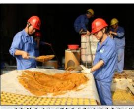
8月21日,热电分厂化学车间组织党员干部对新 系统 3 号混床离子交换器用过的旧树脂进行分离。车 间技术人员经过多次讨论分析、现场试验后,利用阴、 阳树脂在饱和氯化钠溶液所受浮力不同的原理,将旧 树脂中阴、阳树脂成功分离。目前已成功分离出阴树 脂 0.6 吨、阳树脂 0.5 吨, 共节约成本费用 2.47 万元。 图为化学车间人员正在对旧树脂进行分离
