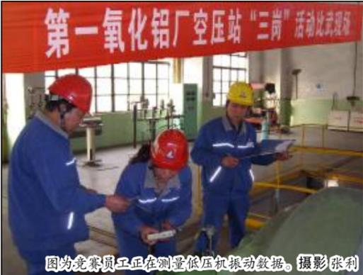
图为竞赛员工正在测量低压机振动数据。摄影张利
