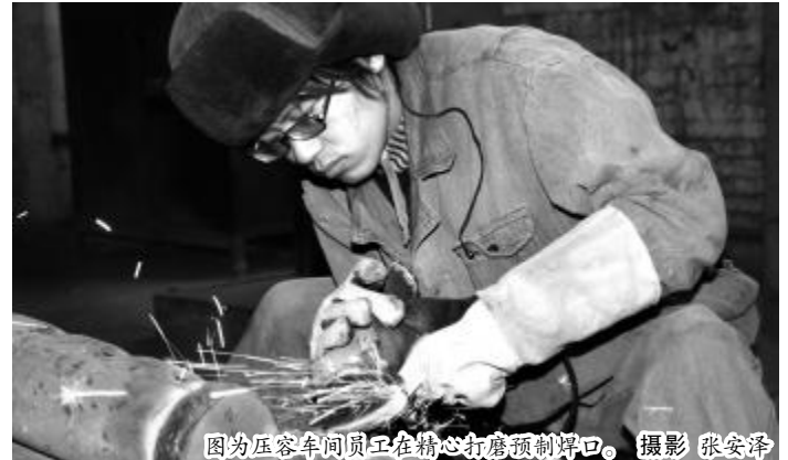
图为压力容器车间员工在精心打磨预制焊口。摄影 张安泽
